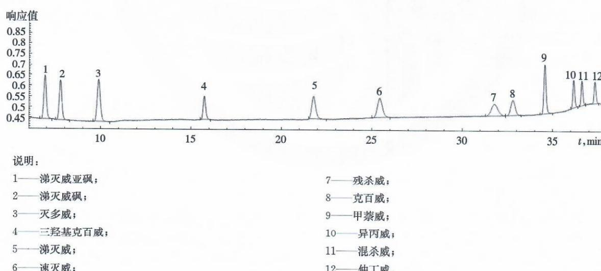
图 1 0.1 mg/L 9 种氨基甲酸酯类农药及其代谢物标准溶液色谱图
